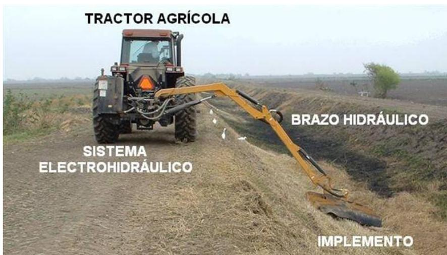
Figura 1. Componentes de un equipo ligero.
