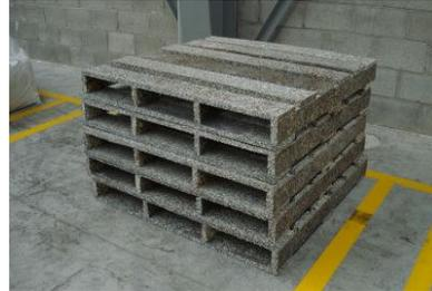
Una vez en la planta recicladora, pasan al área de clasificación y posteriormente a una maquinaria especializada que los hará hojuelas. Finalmente se obtiene la materia prima que será utilizada en la manufactura de diversos artículos como la madera plástica que se muestra.
