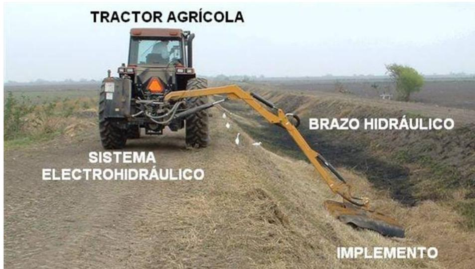
Figura 1 Componentes de un equipo ligero
